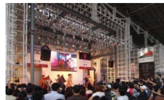
単管格子による屋外ステージ
